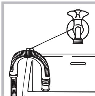
Alternatywnie można oprzeć rurę odpływową na brzegu umywalki lub wanny, przyjmocowując p r o w a d n i c ę (można ją zakupić w punkcie serwisowym) do kurka (zob. rysunek). Wolny koniec przewodu odpływowego
