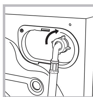
2. Podłączyć do maszyny przewód doprowadzający wodę, przykręcając go do odpowiedniego otworu dopływowego, znajdującego się w tylnej części pralki, z prawej strony u góry (patrz rysunek).
