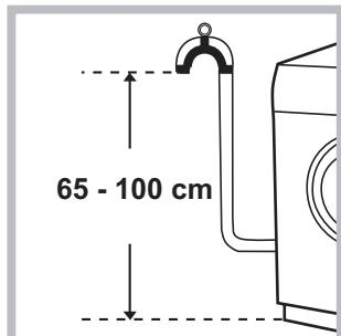
Підключіть зливний шланг, не згиночи його, до каналізаційного каналу або до входу до такого каналу на стіні, на відстані від 65 до 100 см від підлоги;
