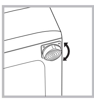
2. Jeśli podłoga nie jest idealnie pozioma, należy skompensować n i e r ó w n o s c i , o d k r ě c a j ą c l u b dokręcając przednie nóżki (patrz rysunek); kąt nachylenia, zmierzony na górnym blacie pralki nie powinien przekraczać 2°.
