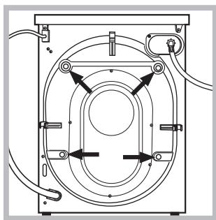
3. Csavarozza ki a gép hátsó részén található, a szál-litáshoz szükséges 4 védőcsavart, és távolítsa el a gumi-bakot (lásd ábra).
