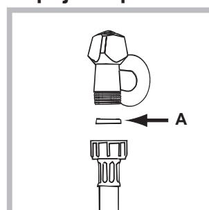
1. Vložte tesnenie A do koncovej časti prítokovej hadice a pripojnite ju k uzáveru studenej vody so závitom 3/4" (vid' obrázok). Pred pripojením hadice nechajte vodu odtieť, až kým nebudete priezračná.
