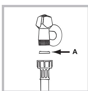
1. Wsunąć uszczelkę A do końcówki rury pobierania wody i przykręcić ją do kurka zimnej wody o gwintowanym otworze 3/4" (zobacz rysunek). Przed podłączeniem spuszczać wodę do momentu, aż stanie się ona całkowicie przezroczysta.
