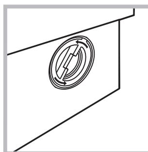
2. odkręcić pokrywę, obracając ją w kierunku przeciwnym do ruchu wskaźówek zegara (patrz rysunek): wypłynięcie niewielkiej ilości wody jest normalnym zjawiskiem;
